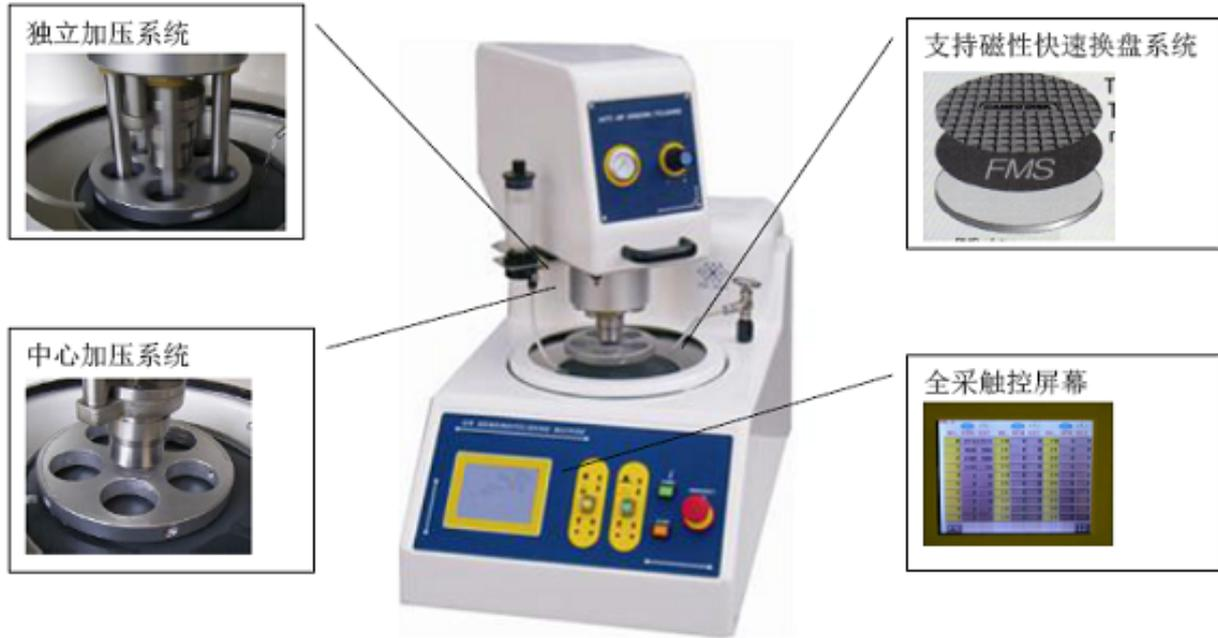
**设备描述:**本机为采用气压控制供给压力，具备单轴独立加压系统及中心整体加压系统的双模式半自动磨抛机，透过快速更换夹具可实现对各种形状及尺寸的试样进行制备，采用独立加压时可以实现对每一个试样供给恒定的压力，使制样达到最佳的效果，并带有条件记忆模块，可以将磨抛过程程序化，是磨抛机中的最佳选择。
