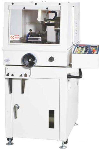
**设备描述：**此机型采用螺杆推动水平进刀方式，自动进刀自动退刀，具备可左右移动式虎钳，提高工作效率
